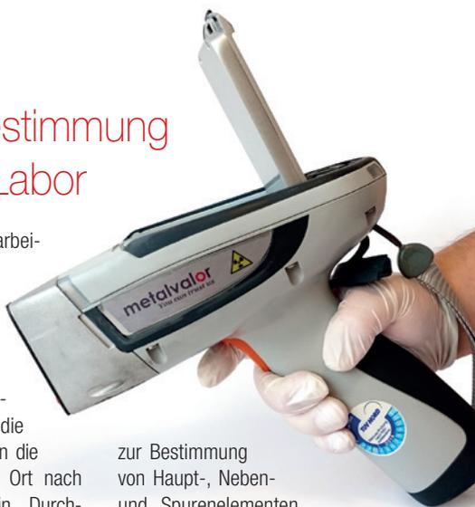
zur Bestimmung von Haupt-, Neben- und Spurenelementen. Dabei wird die Probe mittels Röntgenstrahlung untersucht. Die einzelnen Elemente erzeugen charakteristische Wellenlängen. Durch deren Messung lässt sich präzise feststellen, welche Elemente in welcher Konzentration in der Probe vorhanden sind. Die Ergebnisse werden automatisch gespeichert. Deren Wert kann anschließend, direkt vor Ort, basierend auf diesen präzisen Messwerten, gezahlt werden.
